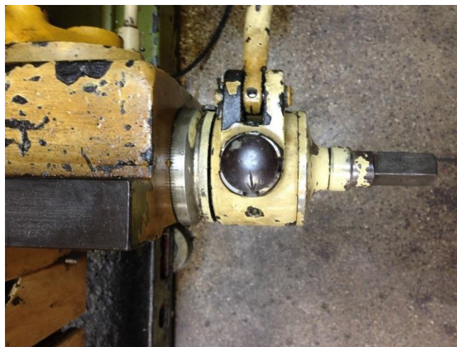
Figura 25 - Pino de acionamento do avanço.
