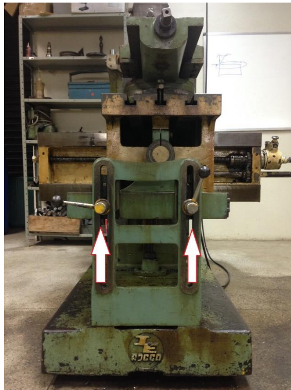
Figura 18 - Alavancas de fixação vertical da mesa.
