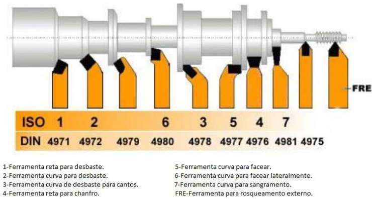
Figura 8 - Tipos de pastilhas normatizadas para uso em usinagem.
