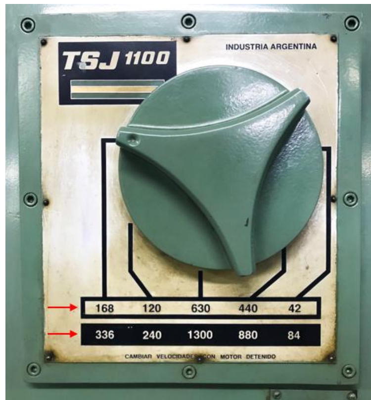
Figura 28 - Seletor de velocidade de rotação do eixo-árvore
