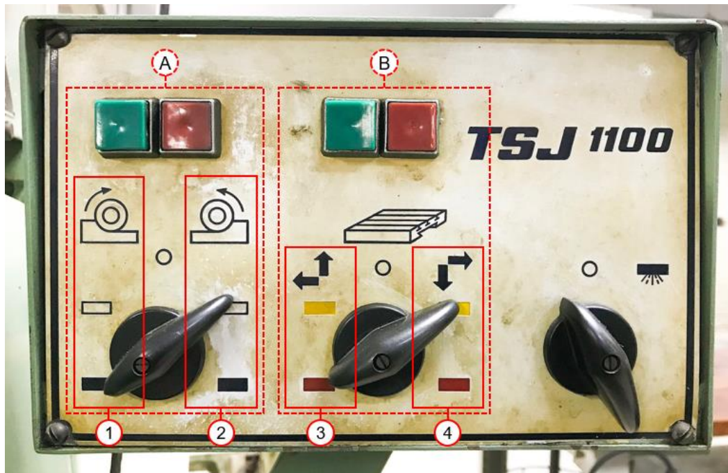
Figura 29 - Painel de controle de sentido de rotação e avanço da mesa
