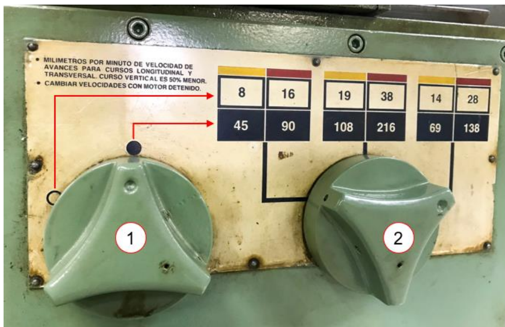
Figura 30 - Seletor de velocidade de avanço da mesa
