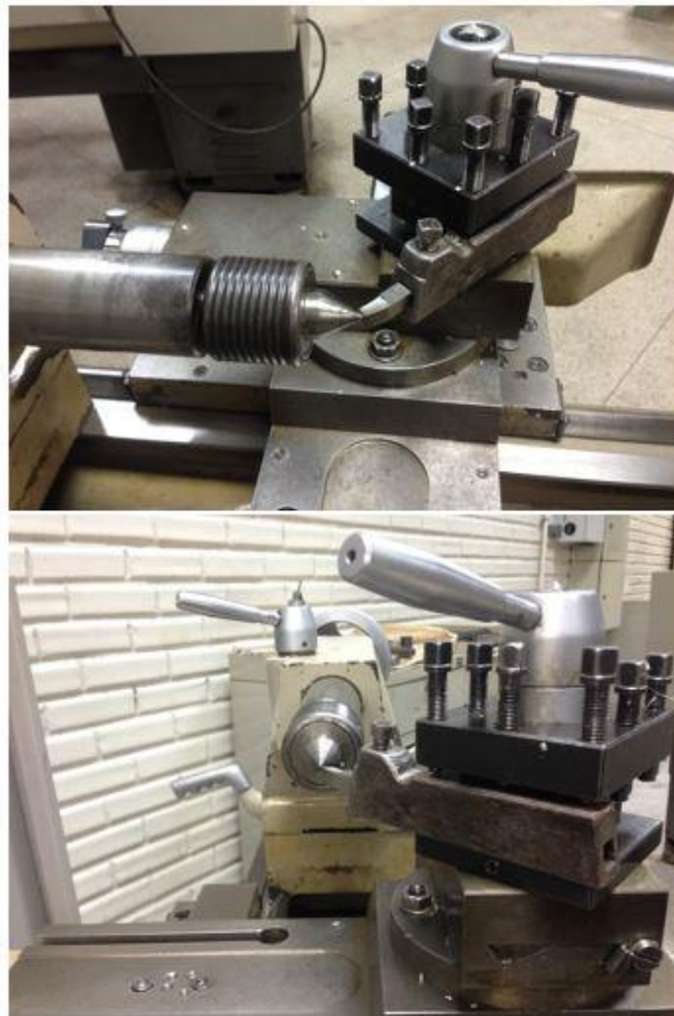
Figura 12 - Forma de centralizar a ferramenta de corte.
