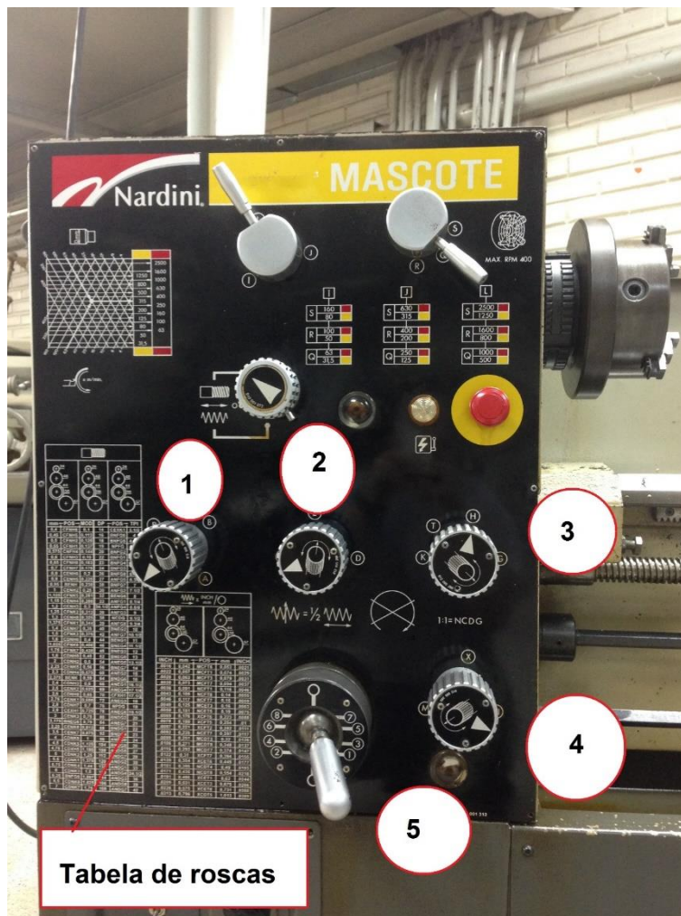
Figura 3 - Detalhe dos comandos de rosca e avanço.
